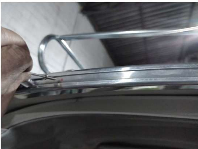
5- la fixer avec les rivet pop, vue gauche et droite, aussi a 3cm du trou (total 4)
